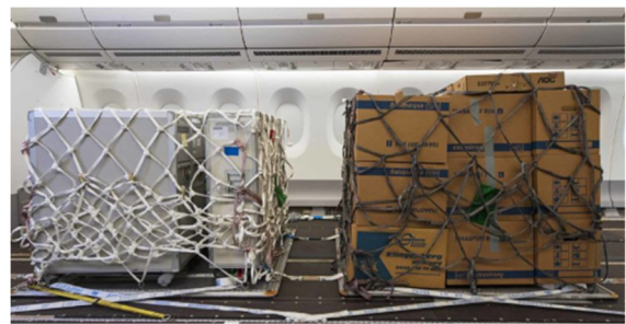
旅客機の座席を取り外して貨物機として使用する例
