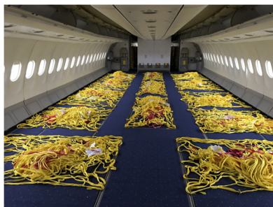
旅客機の座席を取り外して貨物機として使用する例
